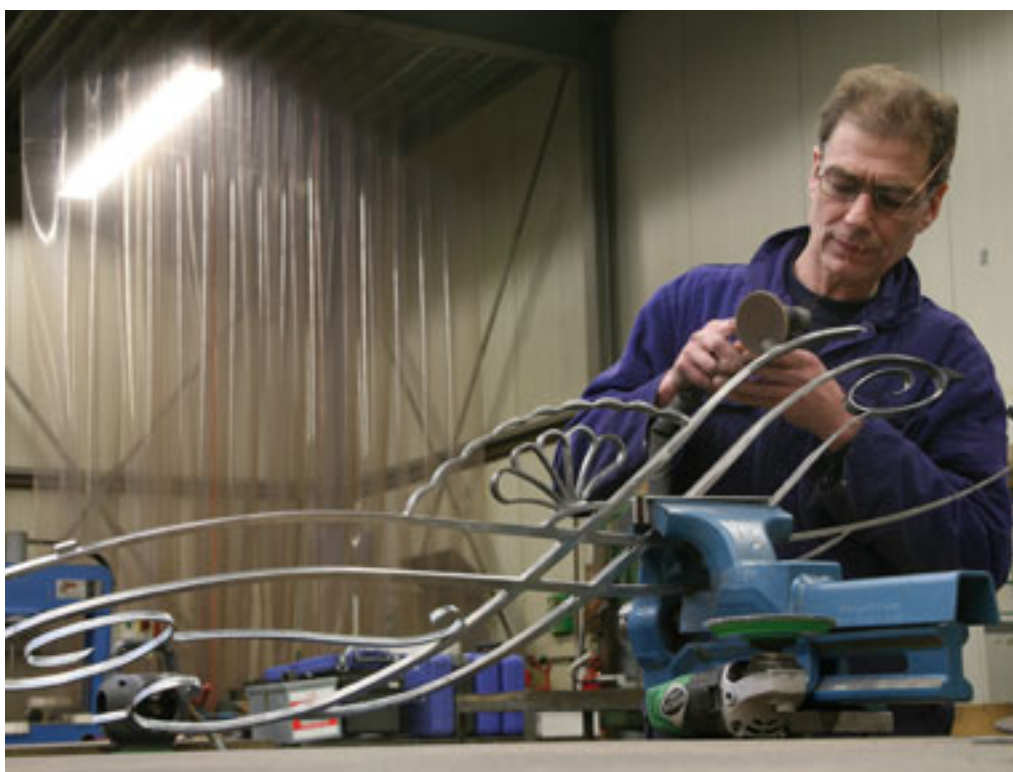
Mattheus Goldsteen: "Een staaf die is getordeerd corrigeer ik door te kloppen, te hameren en nog eens te kloppen om de radius goed te krijgen."
